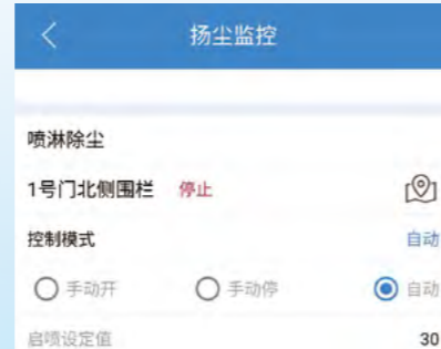
济南项目喷淋自动控制系统
